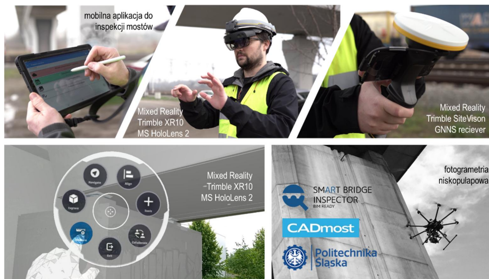
Rys. 5. Urządzenia mieszanej rzeczywistości i aplikacje podczas inspekcji mostu.
