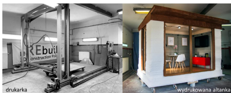
Rys. 8. Polska drukarka kartezjańska do betonu i wydrukowany obiekt (źródło: www.rebuild3dcp.com ).
